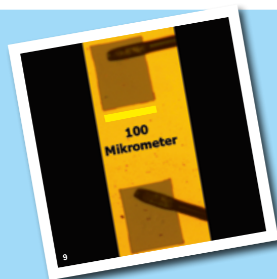
2 LEDs mit Quantenpunkten auf einem Piezosubstrat
