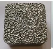
Werkzeugeinsatz aus Stahl 30x30 mm Fräszeit ca. 40 min Fräsen auf Basis .stl Daten
