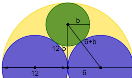
Der Radius  $a = 6$  des blauen Kreises ist die Länge einer Kathete. Die Länge der zweiten Kathete ist der Radius des gelben Kreises minus dem Radius des grünen Kreises, also  $12 - b$ . Die Hypothenuse ist dann  $6 + b$  lang. Mithilfe des Satzes von Pythagoras erhält man
